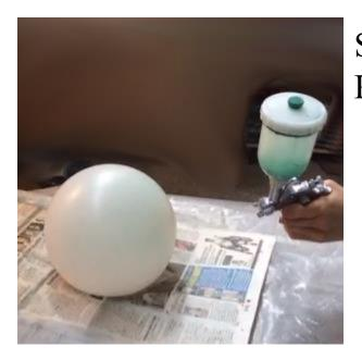
Step B03: Paint 1<sup>st</sup> Layer <u>Max. 3 Bar (Very important)</u> Nozzle 0.8 ~ 1.1mm
